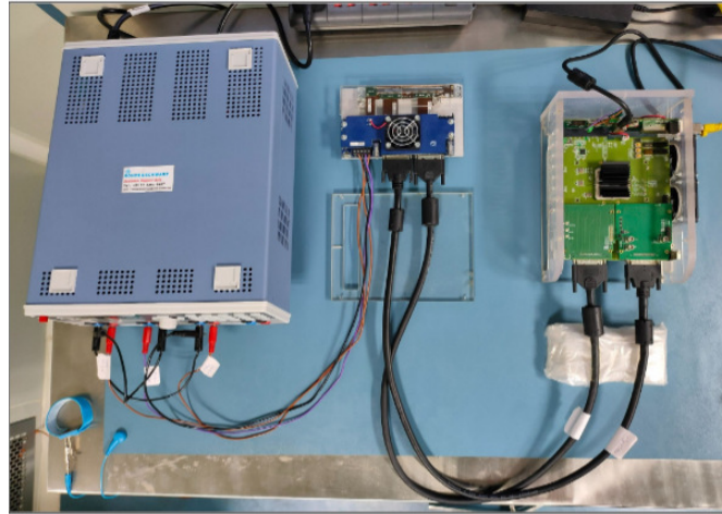
एचईएनपीपी क्लीनरूम में चरण-द्वितीय ट्रैकर मॉड्यूल परीक्षण सेटअप।
